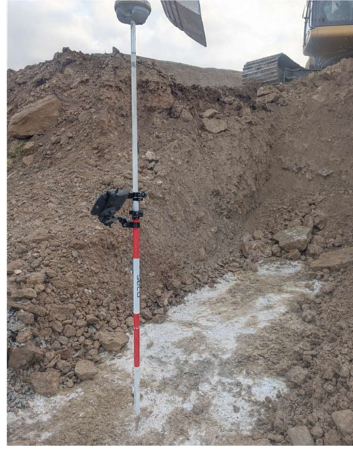
Foto 4.1.5. Punktis P-5/25 (plokis 1 aT) monoliitse lubjakivi pealispind asub 1,76 m madalamal võrreldes varu arvutuse mudelis esitatud kõrgusega. Varasem lasum abs kõrgusel 55,61 m, korrigeeritud lasum abs kõrgusel 53,85 m.
