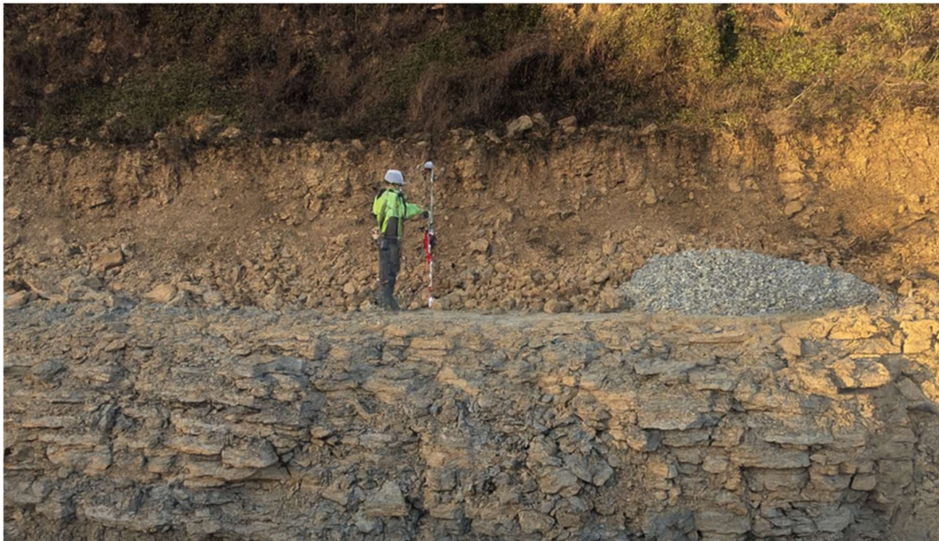
Foto 3.1. Lubjakivi lasumi fikseerimine karjääriseinas punktis P-1/25. Monoliitse lubjakivi pealispind asub 0,93 m madalamal, võrreldes varu arvutuse mudelis esitatud kõrgusega. Varasem lasum abs kõrgusel 56,05 m, korrigeeritud lasum abs kõrgusel 55,12 m (Foto: M. Tammekänd, 02.12.2025).
